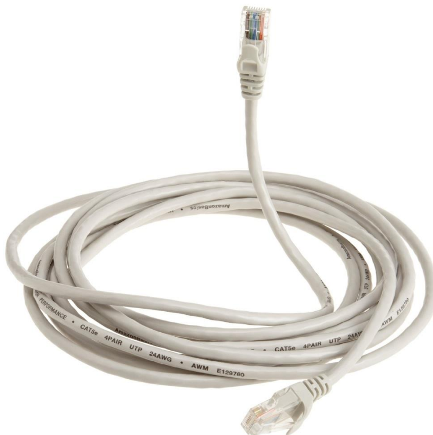
Rysunek 2. Kabel UTP z wtykami RJ45. Wtyki tego typu mają po 8 połączonych styków.
